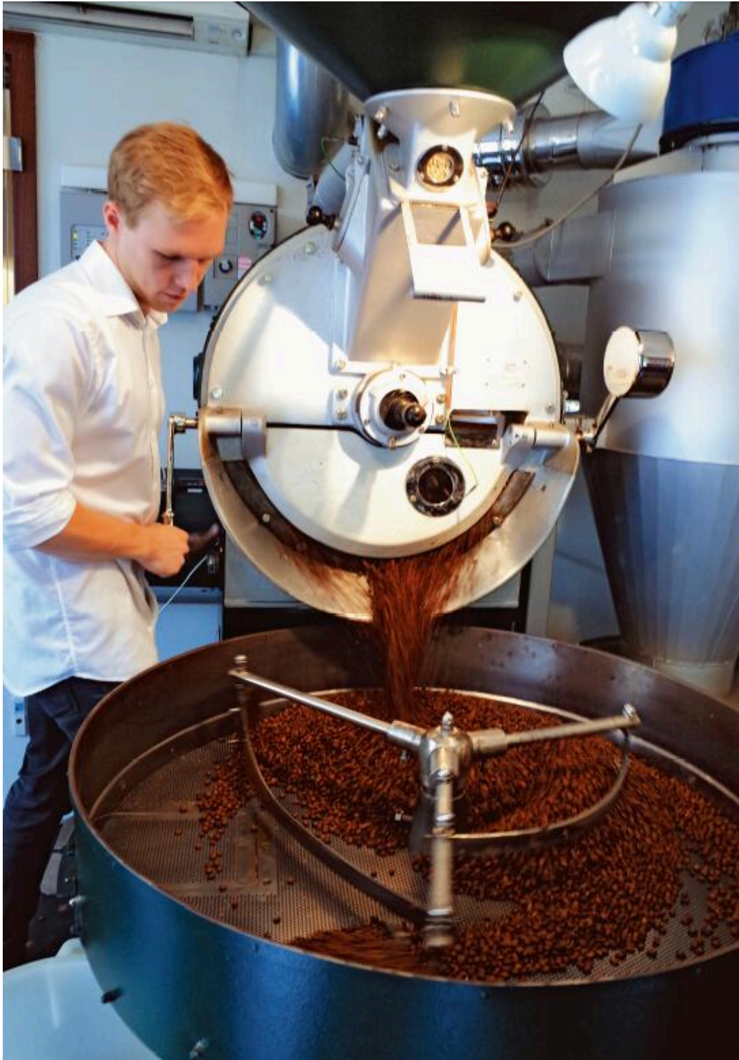
Tim Wendelboe咖啡館的烘豆師，打開爐門，下豆冷卻。入豆漏斗左下方的風門閥已被卸下，改插溫度計（綠色導線），風門保持全開模式，方便烘豆時引入高效率熱氣流。（圖片由陳志煌提供）
